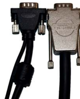
Vergleich Größenverhältnis Ecoflex-Stecker/Standard-Stecker
